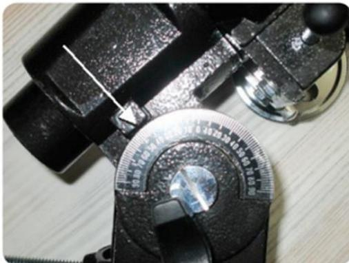
Apoye la montura / telescopio con su otra mano para aliviar la presión sobre el tornillo de ajuste.
