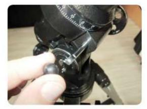
A continuación, conecte los dos ejes flexibles a la montar. Coloque el eje corto "I" en la parte inferior eje (eje de ascensión recto / eje RA). Para hacer esto, Retire la tapa protectora de goma del eje del eje del soporte.
