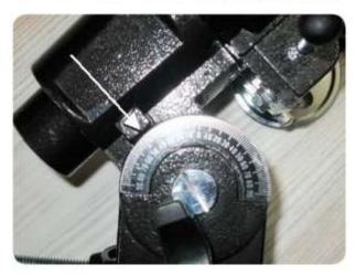
Apoye la montura / telescopio con su otra mano para aliviar la presión sobre el tornillo de ajuste.
