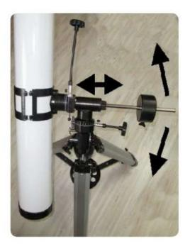
Afloje el tornillo de apriete del contrapeso. Gire el telescopio hasta el eje es horizontal. Sostenga el contrapeso firmemente para evitar que resbale sobre la varilla.
