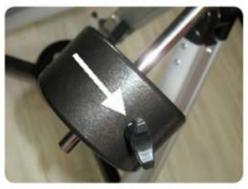
Ahora afloje el tornillo de bloqueo del contrapeso, deslice el peso sobre la varilla y bloquee con el tornillo de bloqueo.
