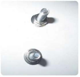
Ahora tome el visor y colóquelo en el tornillos para que pueda atornillar el estriado nueces sobre él. Después de haber atornillado ambas tuercas moleteadas de nuevo en los tornillos, el visor está montado. Al montar el visor, asegúrese de que la apertura del visor El telescopio apunta en la misma dirección que el apertura del telescopio.
