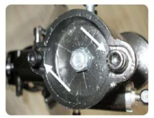
Con la llave Allen adjunta, retire la tornillos provistos para sujetar el tubo abrazadera (s).
