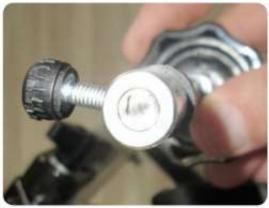
Afloje el tornillo de sujeción del eje y deslice el eje sobre el eje de modo que la sujeción el tornillo está en el lado aplanado del eje. Coloque el eje flexible largo "J" en la parte superior eje (eje de declinación / eje de declinación) en el mismo camino.
