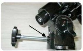
Ahora atornille el tornillo de latitud "3" en el hilo proporcionado para este propósito en el montar. Mediante este tornillo puedes ajustar la altura del poste.
