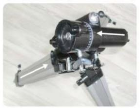
Coloque el cabezal de montaje de modo que el eje superior (eje de declinación) está alineado con una pata de trípode.
