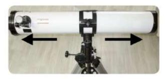
Mueva el contrapeso al extremo inferior de la varilla del contrapeso y fíjela allí. Gire el eje RA para que el contrapeso está en la posición más baja y sujete el eje en esta posición.
