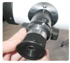
Ahora mire por el telescopio buscador desde atrás (se muestra en la imagen adyacente en el Derecha). Usando el ajuste tornillos (2), ajuste el buscador hasta que veas lo mismo objeto como en el ocular. El enfoque se realiza girando el ocular. Ajuste el visor para que el objeto seleccionado es exactamente en el centro detrás la mira o detrás del punto iluminado.
